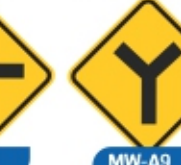
MW-A8 Interseção em "T"
